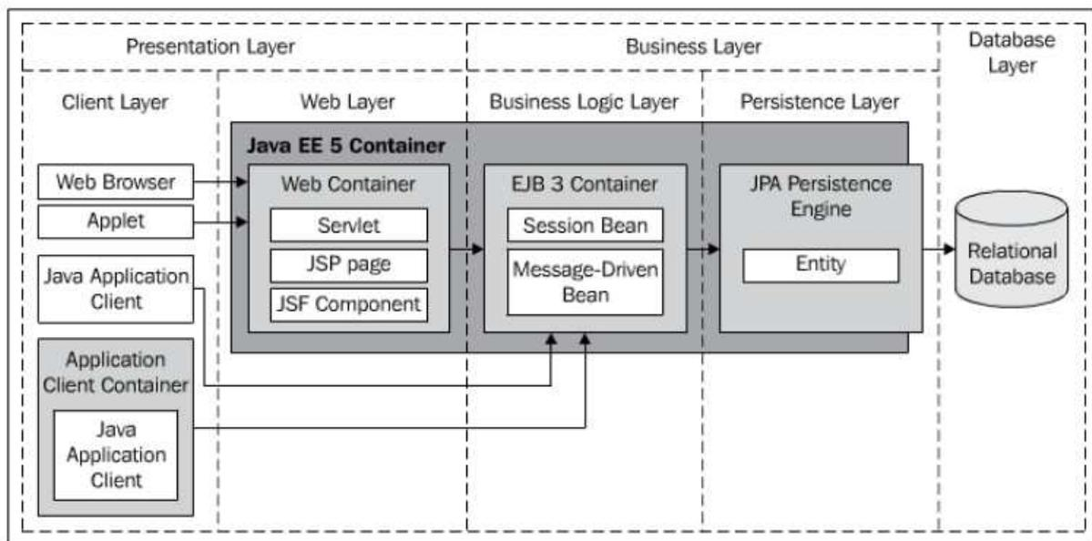
Ce schéma représente le modèle d'architecture du Framework J2EE.
